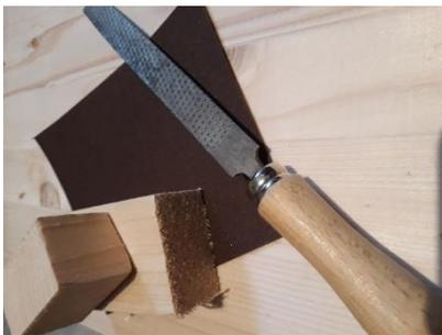
Zuerst werden die Holzstücke mit Schleifpapier (in der Tüte) oder einer Feile etwas glatt geschliffen.
